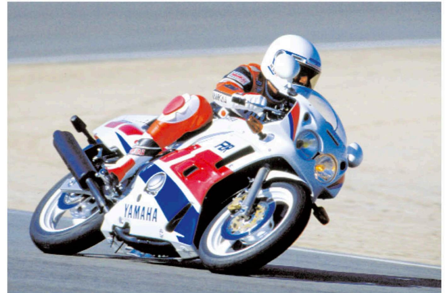
Telegabel mit den dicken 41er Standrohren ließ sich wie das Federbein des Monocross-Systems im Heck stufenlos in Federvorspannung und Dämpfung verstellen.
