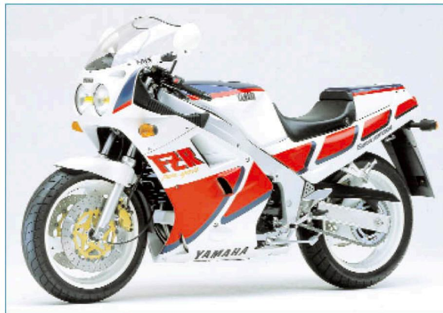
sr. und Eddie Lawson. Für die FZR 1000 wog das LM-Chassis inklusive der Unterzüge und des ebenfalls angeschraubten Heckteils gerade einmal 16 kg. Ähnlich wie beim Vierkantröhren-Stahlrahmen der FZ 750 verliefen die gewaltigen Leichtmetallprofile mit Außenwölbungen im Bereich der Vergaserbatterie direkt vom Lenkkopf zur Schwingenaufnahme.
