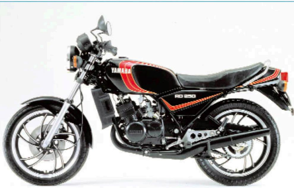
Gewand wie Phönix aus der Asche wieder aufstehen. Bei Yamaha wurde das Problem durch die Ablösung der alten Zweitakter mit Luftkühlung durch völlig neu entwickelte Maschinen mit Flüssigkeitskühlung gelöst. Die nötige Erfahrung hatten die Ingenieure bereits auf der Rennstrecke sammeln können: Die damals schon seit vielen Jahren flüssigkeitsgekühlten Production-Racer der TZ-Baureihe hatten mit zahllosen Siegen ihre Qualitäten und ihre Standfestigkeit unter Beweis gestellt.
