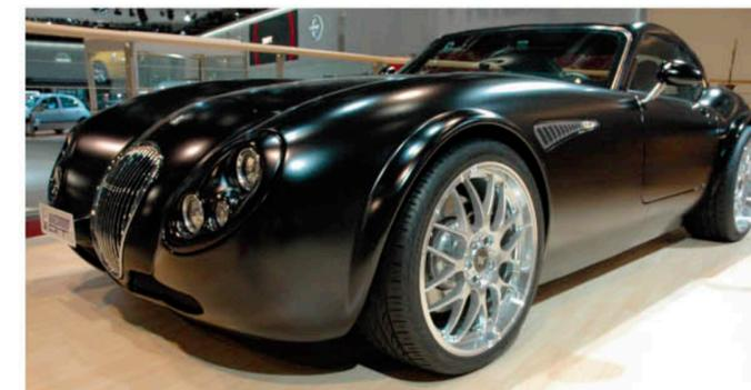
Links und oben: Der GT hat größere Lufteinlässe als der MF3, um den erhöhten Kühlluftmassenstrombedarf des V8-Motors zu erfüllen. Mit den weit ausgestellten Radhäusern und den großen Rädern steht der Wiesmann GT satt auf der Straße. Unten: der erste mattschwarz lackierte Wiesmann GT auf der Frankfurter IAA 2005.
