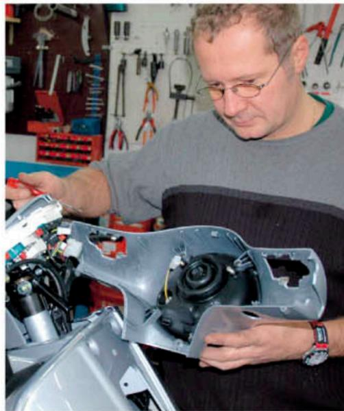
**Innenschild ausbauen:** Während die Karosserie mit dem vorderen Beinschild wie bei allen klassischen Vespa-Modellen aus einer tragenden Stahlblechkonstruktion besteht, ist das innere Schild inkl. Handschuhfach aus Kunststoff hergestellt. Es muß abgenommen werden, wenn an Kühlanlage oder Lenkschloß gearbeitet werden muß. Vorher ist der Ausbau der Lenkerverkleidung zu empfehlen.
