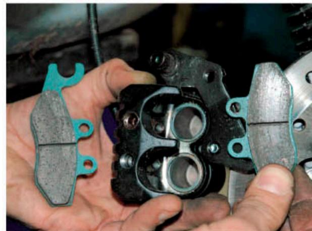
Links unten: Trennen der Vorderrad-Sattelhälften. Oben rechts: Sattelhälften und ausgebaute Bremsbeläge vorn. Unten rechts: Bremssscheibe vorn mit nach hinten gezogenem Schwimmsattel.
