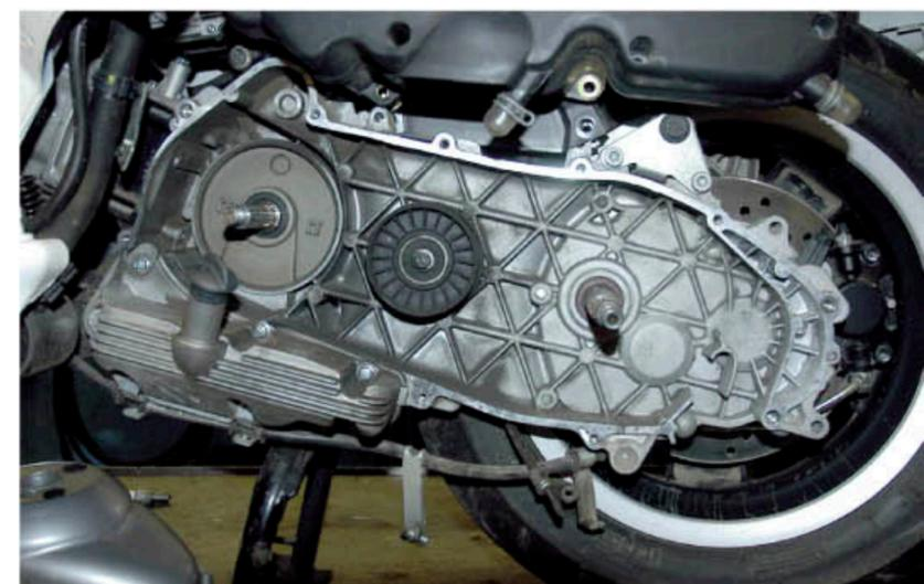
Oben: Abnahme der angetriebenen Einheit samt Kupplung
