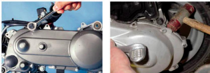
schlüssel und Umschaltknarre ausgedreht. Zum Abnehmen muß in der Regel mit leichten **Gummihammerschlägen** von der Rückseite her nachgeholfen werden. Bei den Modellen mit **Stützlager** Dekkel vorsitzig vom Lager treiben. Der Gummihammer hilft auch bei den Viertaktern, wenn die beiden **Paßhülsen** vorn und hinten festsitzen.
