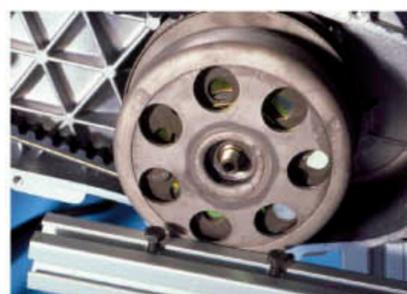
Oben: Kupplung der Vespa ET 2 mit zentraler Verschraubung. Unten: Zum Lösen der Mutter muß die Kupplungsglocke blockiert werden. Wir haben uns den Hebel mit Aluminiumprofil und zwei Bolzen selbst gebaut.
