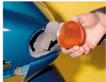
**Blinkerausfall - Prüfung:** Wenn die Blinker ausfallen, kann das mehrere Ursachen haben: Lampen- und Kabeldefekt, korrodierte oder abvibrierte Anschlüsse, defekter Blinkgeber oder Fehler im Bereich der Zündelektronik. Wir schildern am Beispiel der **LX 125**, was bei einem vermuteten Elektronikdefekt zu tun ist, um die Fehlerursache zu finden:
