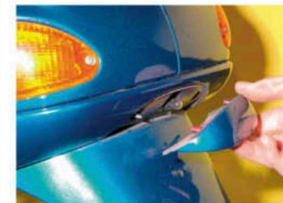
**Hupe - Ausbau:** Die Hupe ist nach Abnahme der Frontblende bestens zugänglich. Zum Ausbau die große zentrale KS lösen, die den Halter am Rahmen befestigt. Stecker abziehen und Hupe abnehmen.
