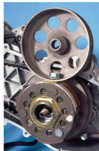
**Treibende Riemenscheibe, Antriebsriemen, Kupplungseinheit, Anlassergetriebe - Ausbau:** Antriebsriemen und Kupplung kommen erst frei, wenn auch die **vordere Riemenscheibe** abgenommen ist. Sie ist ebenfalls mit einer Mutter SW 15 fixiert, die durch ein Neuteil ersetzt werden und
