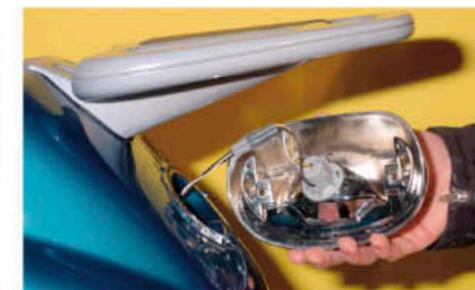
Oben links: Die Verglasung der ET-Rückleuchte ist mit zwei KS befestigt. Unten: Ausbau des Reflektors.
