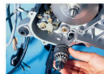
Foto linke Spalte unten: bei abgenommener Kupplungsglocke wird die eigentliche Kupplung sichtbar. Oben: Elemente des Variators und der treibenden Riemenscheibe in ausgebautem Zustand. Unten: Das Anlasservorgelege greift in das große Ritzel am Variator und läßt sich einfach aus dem Gehäuse ziehen.
