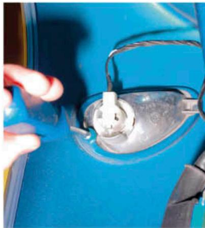
Links: Demontage des vorderen Blinkergehäuses der ET bei abgenommenem Handschuhfach. Rechts: vorderer Blinker der LX. Mitte von links: Blinker LX hinten, Ausbau Blinker vorn ET 4.
