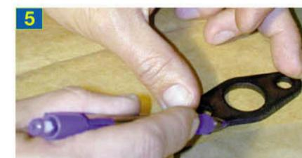
**2** Zur Not tut es auch eine 0,5 mm dicke Aktenpappe. Man legt die alte Dichtung auf, zeichnet sie nach, schneidet die neue aus – und die Panne kann behoben werden.
