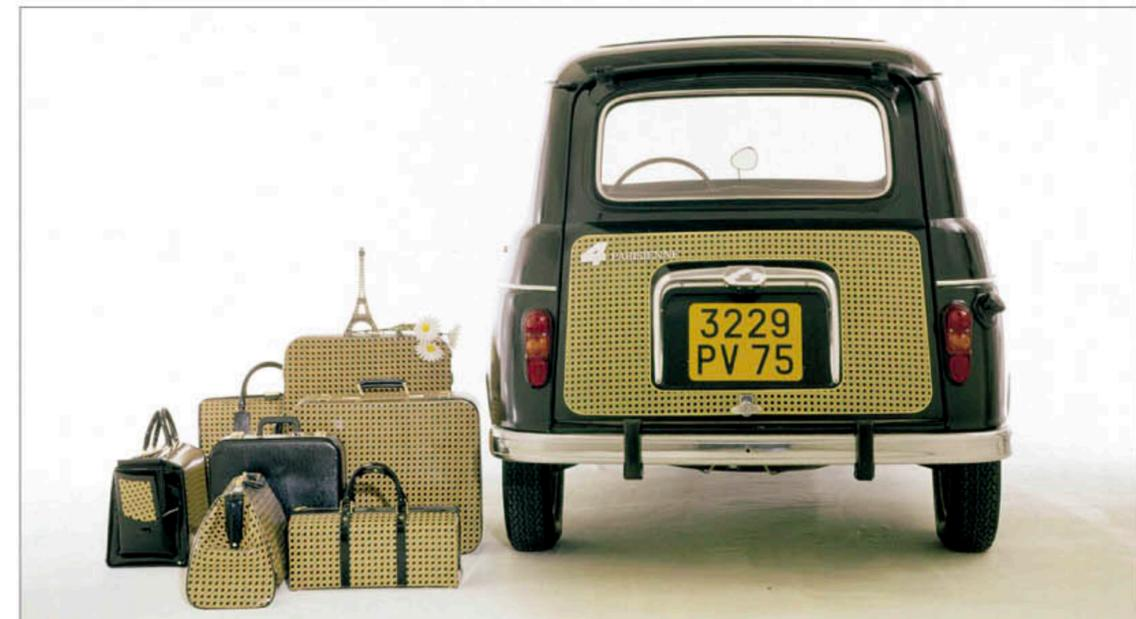
*En haut : La « Parisienne » devient désormais un modèle à part entière et se positionne tout en haut de la gamme R4. On voit ici un modèle identique à celui qui était proposé aux lectrices du magazine Elle. Mais pour la production, le cannage sera supprimé à la partie supérieure des portes et ailes AR et s'arrêtera au niveau de la poignée de porte AV. Les filets de couleur étant supprimés.*
