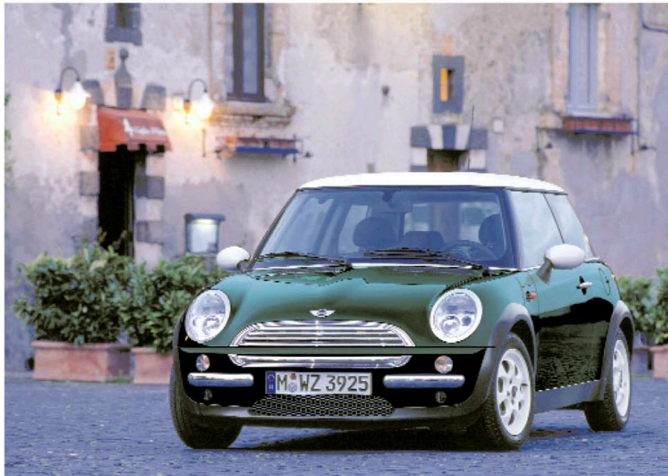
So wurde der Mini Cooper im Mai 2001 erstmals der Presse vorgeführt. Der 1,6-Liter-ohc-16-Ventil-Motor leistet 115 PS und sorgt für rund 200 km/h Spitze. Die gleich starke Automatik-Version mit CVT-Getriebe ist etwas langsamer.
