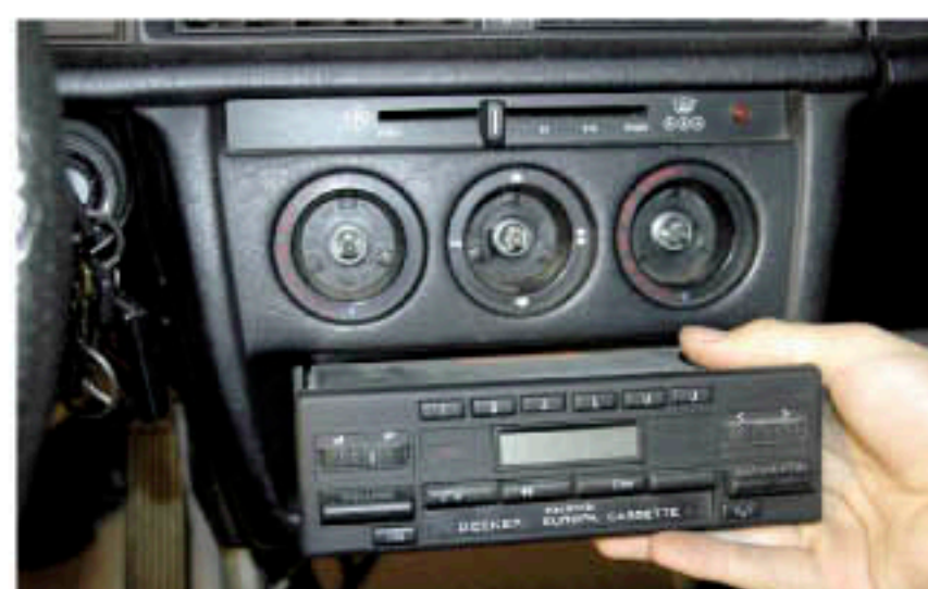
Oben links und rechts: Die Bedienknöpfe der Heizung zieht man mit einer Zange ab (Lappen zwischenlegen); die darunter liegenden Muttern SW 24 können dann abgeschraubt werden.
