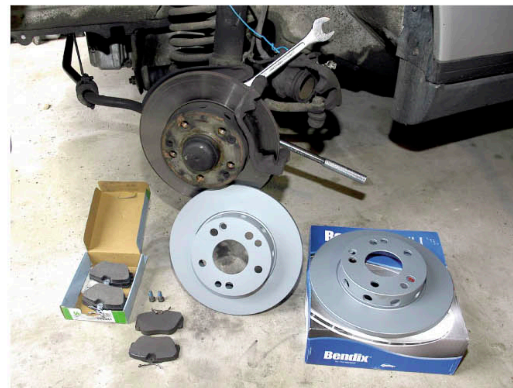
Oben links, rechts: Zum Ausbau der Bremsscheibe muß der Bremsträger von der Radnabe abgeschraubt werden. Großes Foto: Satz neuer Bremsscheiben und Beläge.
