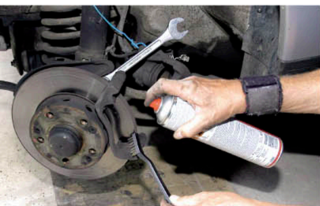
Oben: Die Beläge werden einfach aus dem Bremsträger gezogen. Unten: Die Gleitflächen mit Drahtbürste und Spray reinigen.
