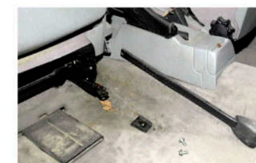
Oben: Herausnahme des Sitzes, Blick auf die Schienenführung am Mittelunnel. Platten und Gewindeklammern vor dem Einbau positionieren. Unten links, rechts: Lösen der Sicherheitsgurt-Befestigungen (SW 17).
