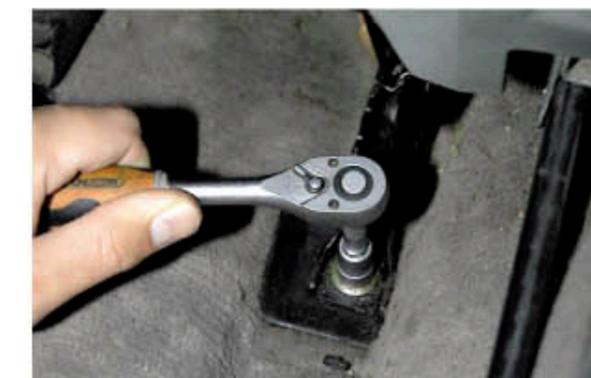
Links: Lösen der elektrischen Radioantenne nach Ausbau der Seitenverkleidung. Oben links und rechts: Lösen der Schrauben vorn an den Sitzschienen nach Abnahme der Kappe. Unten links: Lösen der Schrauben hinten.
