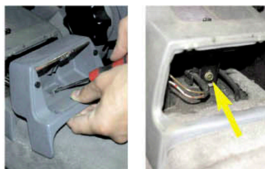
Oben: Abziehen von Griff und Abdeckung am Handbremshebel. Unten: Ausbau der mittleren Konsole über dem Kardantunnel; Blick auf die rückwärtige Verschraubung.
