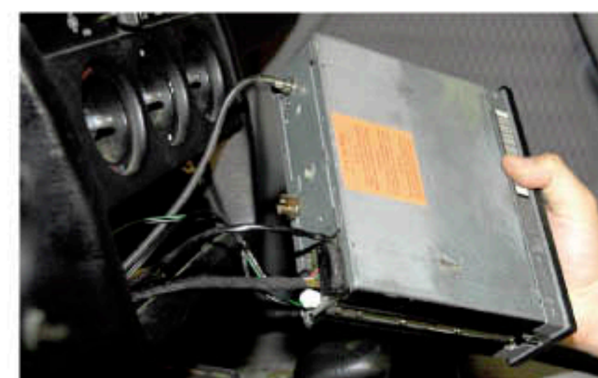
Mitte links und rechts: Das Becker-Radio läßt sich mit seinen Anschlüssen rausziehen.
