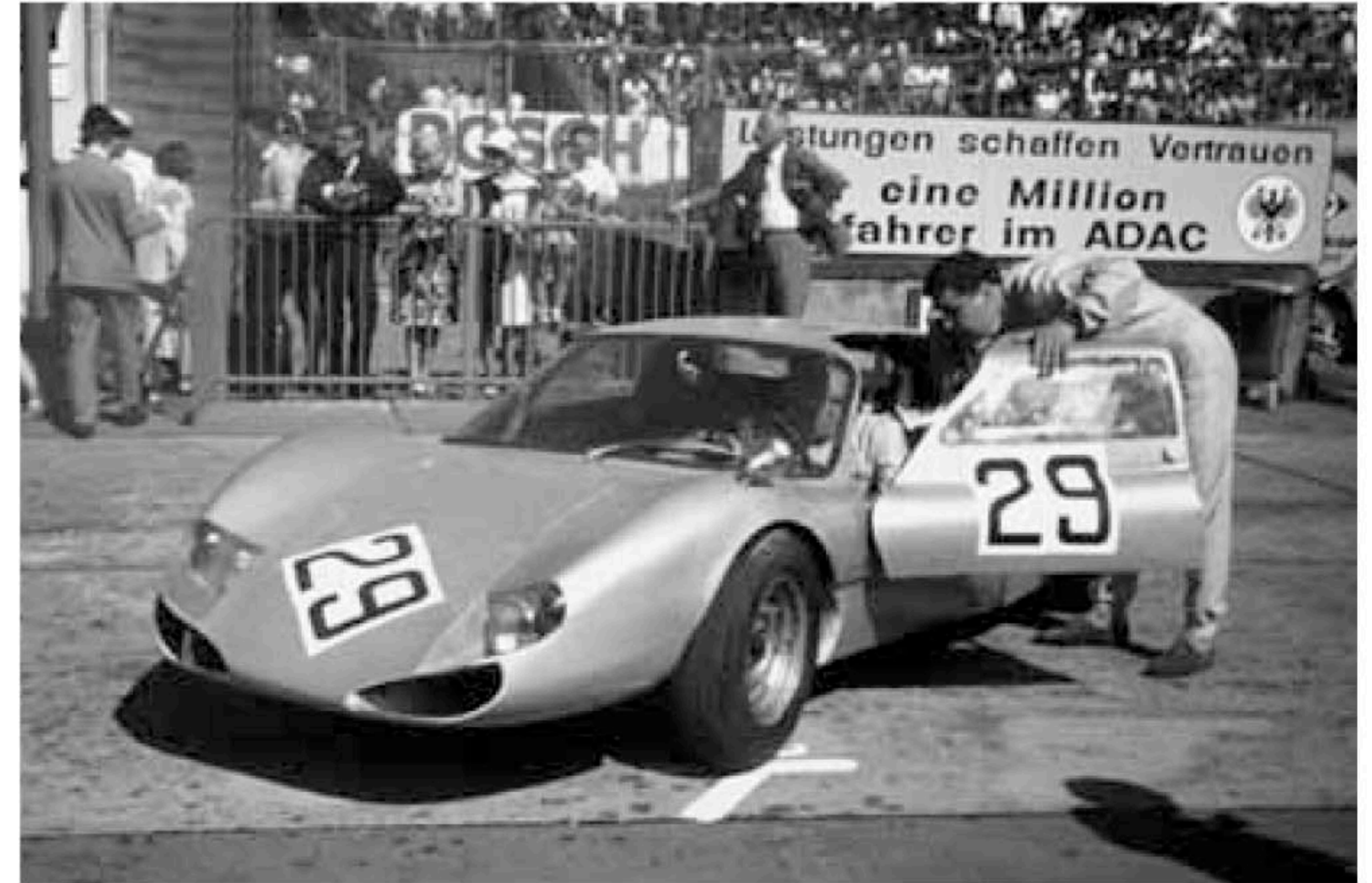
Wegen eines Zündkabel-Defekts konnte das 1600er Mittelmotor-Coupé das 1000-km-Rennen nicht aufnehmen. Oben: Pilot Louis am Volant. Unten: Willi Martini betrachtet den Wagen kurz vor dem Start noch einmal kritisch. Leider wurde die sehr interessante Konstruktion nicht weiterverfolgt.
