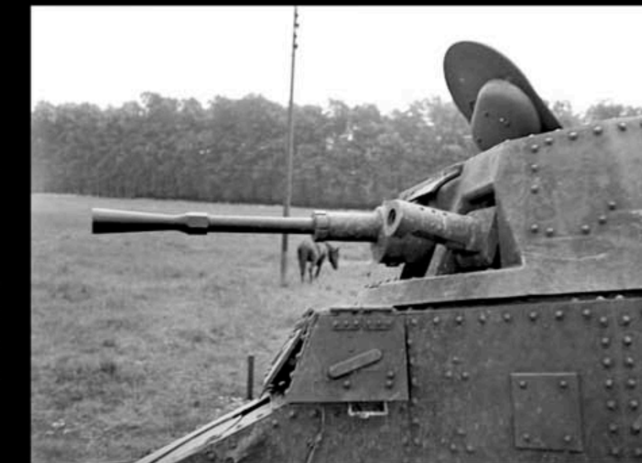
En bas à droite : détail du Panhard 178, équipé d'un canon semi-automatique de 25 mm, modèle 1934, et d'une mitrailleuse Reibel modèle 1931 de 7,5 mm en armement coaxial.
