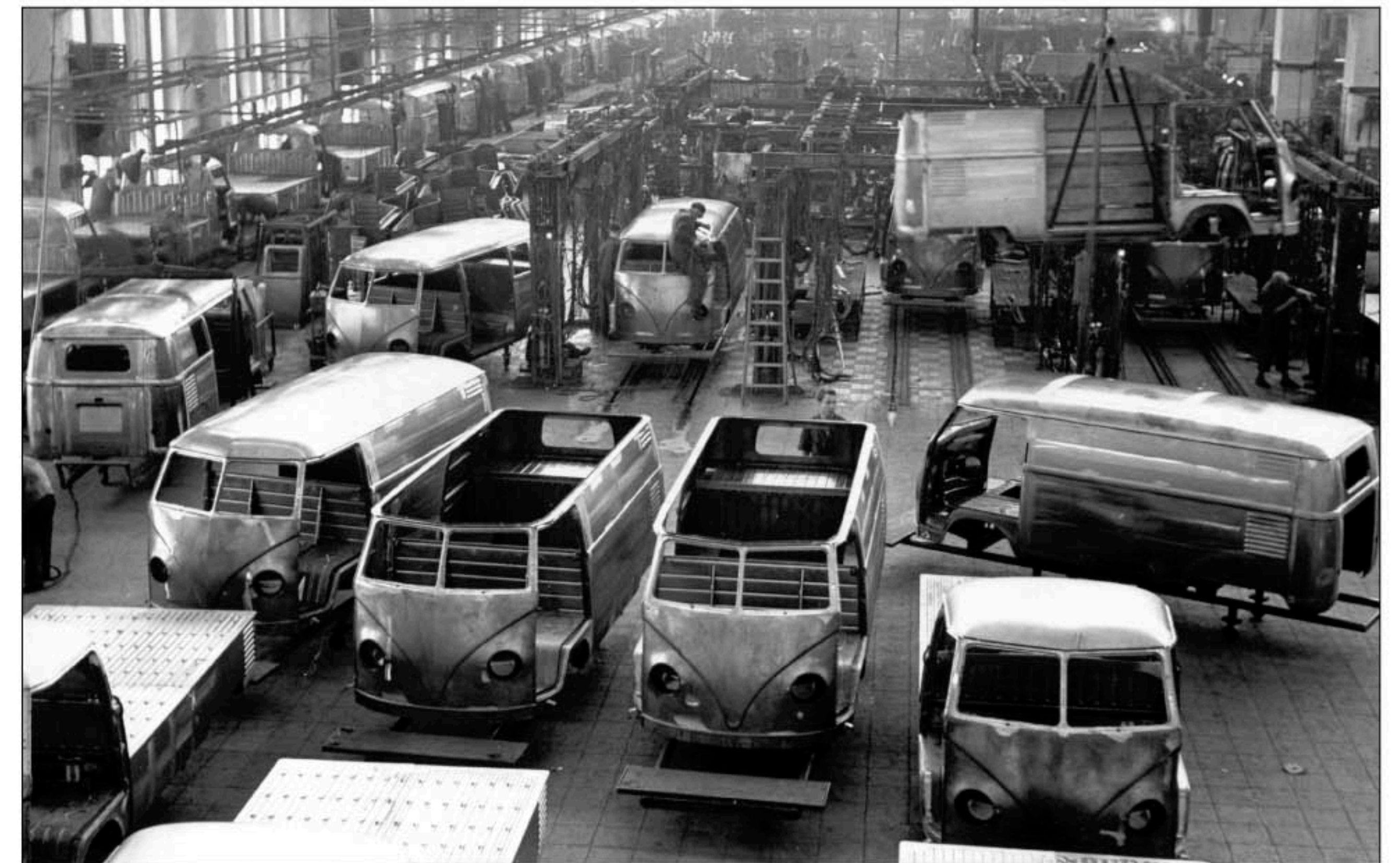
Links (1956): Vor dem Spachteln werden die Bleche sorgfältig geschliffen und notfalls mit dem Hammer nachbearbeitet. Unten: Blick in die Karosserie-montage 1953.
