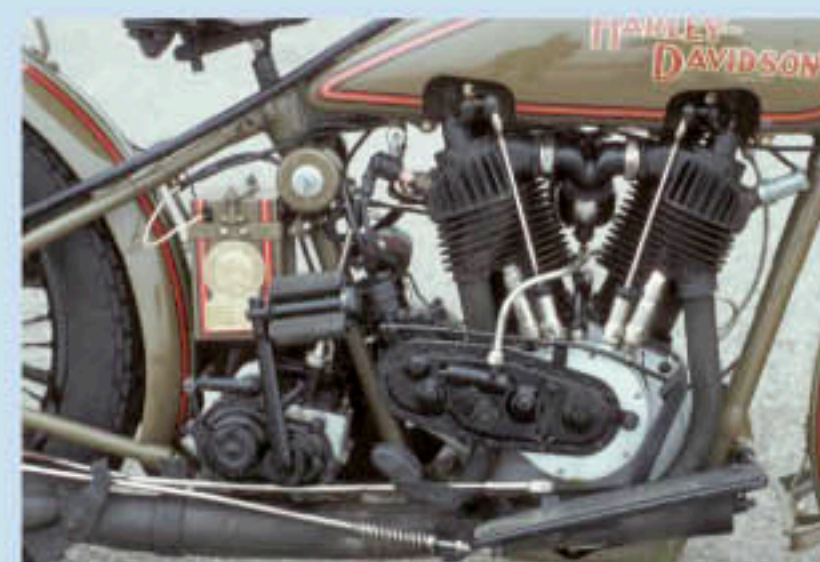
Pedalstarter, freiliegende Stößelstangen, Auspuffklappe: V-Twin des J-Modell von 1925
