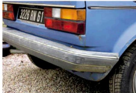
Links: Die Heck-Stoßstange hat einige Remppler abbekommen und wurde dabei leicht nach oben gedrückt. Auch ist die Zierleiste recht unansehnlich. Der Kunststoff läßt sich mit einem Spezialmittel auffrischen, die Schiefelage aller Erfahrung nach relativ einfach beheben. Die Stoßstangenhalter sind nur mit vier Schrauben im Kofferraum befestigt, der Ausbau ist ein Kinderspiel. Die hohe Reparaturfreundlichkeit ist es, die den alten Golf von modernen Nachfolgern unterscheidet.
