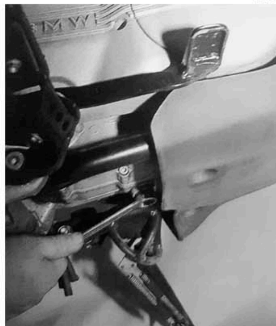
Abb. 279 Die Ablassschraube an der Motorunterseite könnte besser zugänglich sein.
