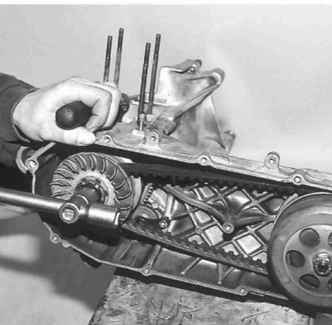
Bild oben: Antriebseinheit eines Booster Track in teilzerlegtem Zustand; Variator und Anfahrkupplung liegen hinter der vorderen Riemenscheibenhälfte mit dem Gebläsefächer. Der Zahnkeilriemen führt zur Fliehkraftkupplung (zu sehen: nur die Kupplungsglocke). Dahinter liegt der Getriebedeckel mit dem Lager für die Antriebsachse. Unten: Gehäusedeckel mit Kickstarteranlage. Photo au-dessus: Le motopropulseur d'un Booster Track en état de décomposition partielle; Le Variateur et l'embrayage du démarreur se trouvent en avant derrière le ventilateur. La courroie donne sur l'embrayage type centrifuge; on peut voir ici seulement le logement de l'embrayage. Derrière: Le couvercle de la boîte de vitesses avec le roulement arrière. Au-dessous: Le couvercle de la transmission avec les éléments du kick.
