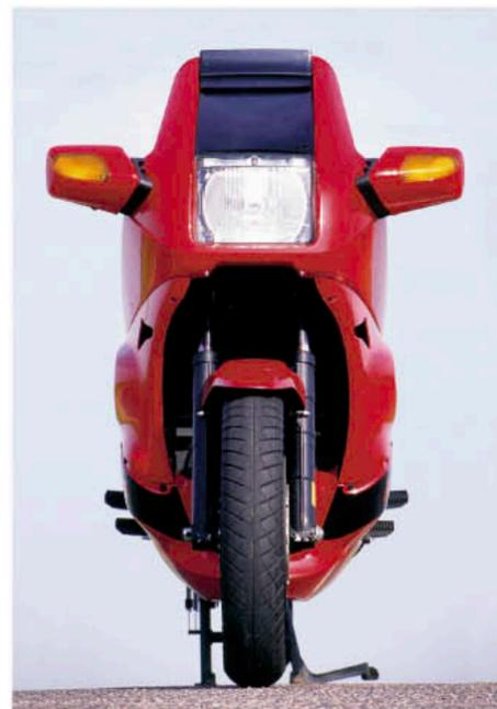
unveränderte Oberseite der RS-Verkleidung hatten die Designer weit nach hinten und unten gezogene Seitenteile sowie einen mächtigen Motorspoiler mit markentypisch nierenförmigem Kühlluftinlaß angefügt.
