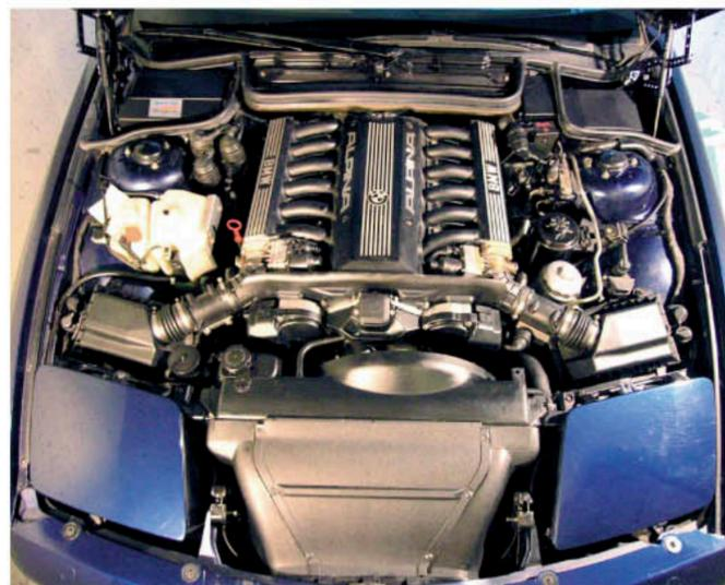
V12-Motors von 300 PS (220 kW) bei 5200/min<sup>-1</sup> auf 350 PS (257 kW) bei 5300/min<sup>-1</sup> gesteigert werden. Gleichzeitig erhöhte sich das maximale Drehmoment von 450 Nm bei 4100/min<sup>-1</sup> auf 470 Nm bei 4000/min<sup>-1</sup>. Die Höchstgeschwindigkeit des BMW ALPINA B12 5.0 Coupés wurde mit über 280 km/h angegeben und die Beschleunigung von 0 auf 100 km/h mit 6,8 Sekunden.
