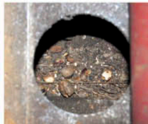
Petite photo : il arrive parfois de trouver des traces de rongeurs dans les cavités du dessous de caisse.
