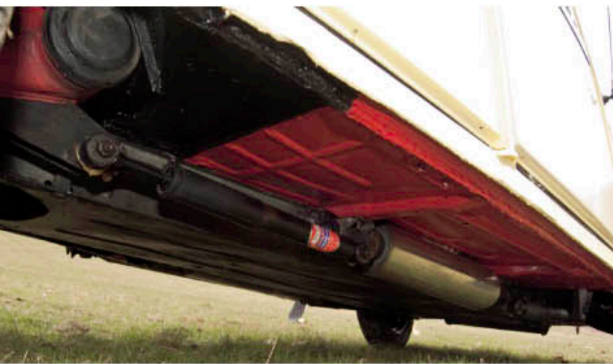
Ci-dessus à gauche : un dessous de caisse bien entretenu avec un pot de suspension recouvert d'acier inoxydable. En-dessous : soulèvement de la 2 CV avec un cric hydraulique pour un contrôle de routine. Ci-dessus à droite : bras oscillant et arbre de transmission d'une 2 CV6 entre juillet 1979 et juillet 1987.
