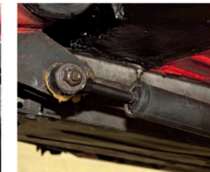
Au milieu de gauche à droite : connexion entre le pot de suspension et le bras oscillant. L'œillet en métal du tirant présente une fissure sur la surface d'appui du couteau de suspension. En bas de gauche à droite : des amortisseurs neufs et fraîchement graissés.
