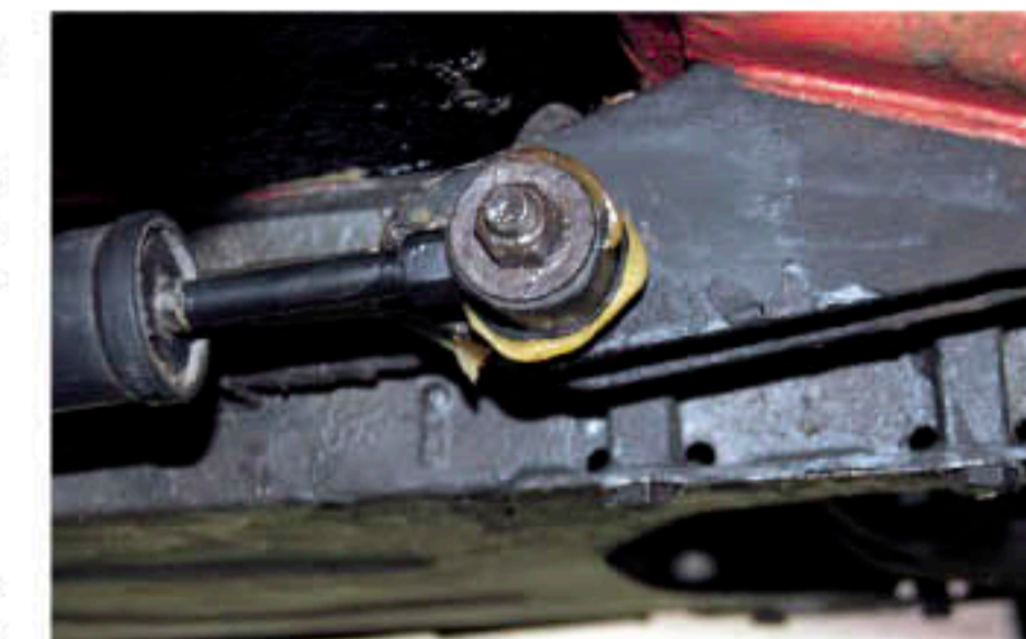
Großes Foto oben: Nach Abnahme der Karosserie nimmt Vincent erschrocken zur Kenntnis, wie verdreckt und verrostet der Rahmen des AZAM von 1966 ist. Immerhin läßt sich das Chassis hinten anheben.
