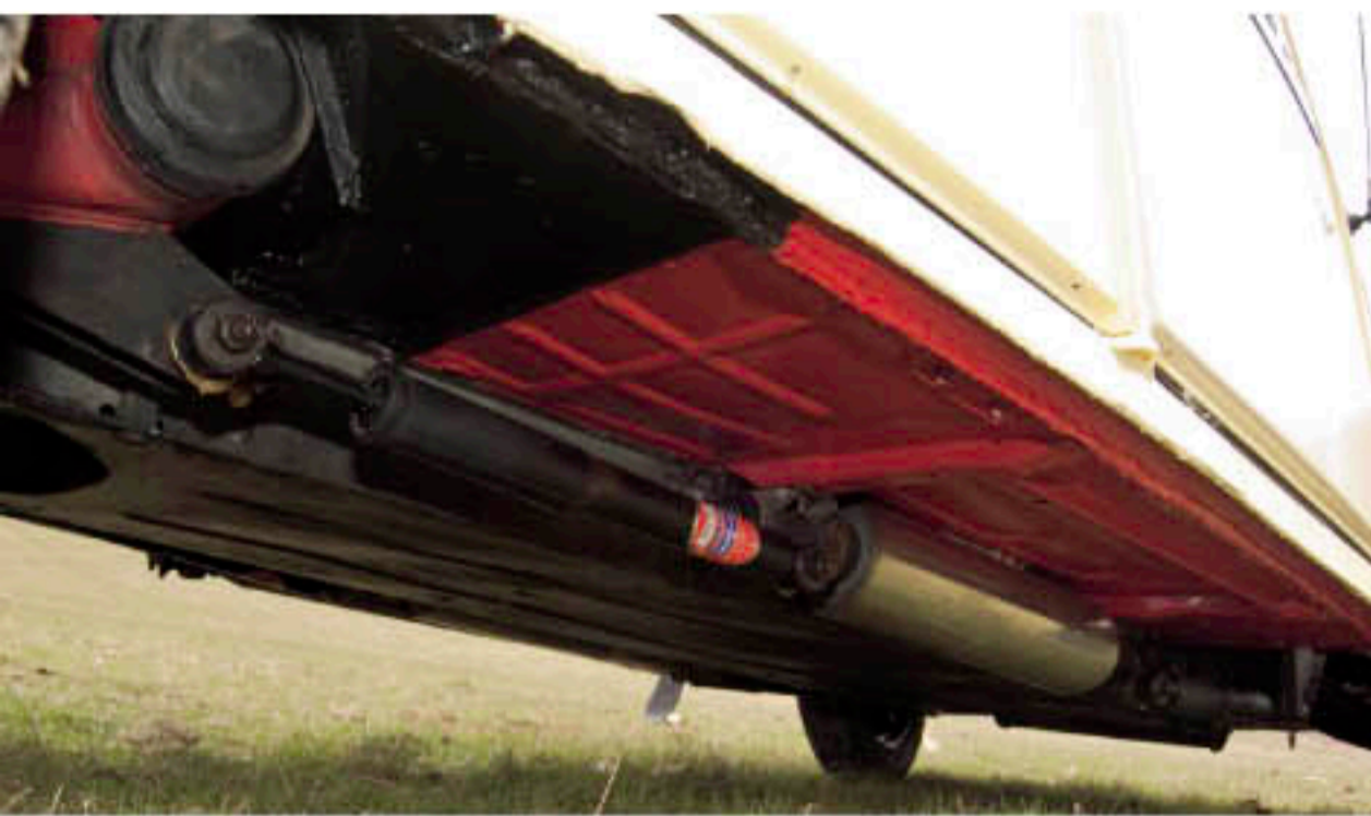
Oben links: gut gepflegter Unterboden mit edelstahlummanteltem Federtopf und neuen Stoßdämpfern. Darunter: Anheben des 2 CV zur Routinekontrolle mit Hydraulik-Wagenheber.
